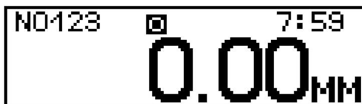
2.3.1.2 В верхнем поле дисплея отображаются (слева направо): порядковый номер измерений, режим работы (**о** – оперативный; **ж** – ждущий; **н** -наблюдений), время проведения измерений. В центре дисплея выводится значение перемещения в миллиметрах.
