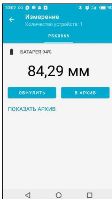
При нажатии кнопки «ОБНУЛИТЬ» происходит автоподстройка прогибомера с установлением нулевого значения. При нажатии кнопки «В АРХИВ» результаты измерения записываются в память прибора.
