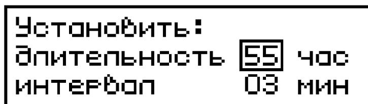
Клавишами ↓ (↑) установить требуемое значение длительности измерений и нажать **ВВОД**. Указатель курсора переместится на пункт «интервал». Клавишами ↓ (↑) установить требуемый интервал измерений и нажать клавишу **ВВОД**.
