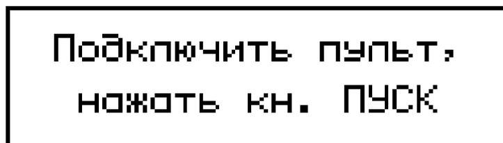
Включить питание выносного пульта, сдвинув флажок, расположенный с правой стороны пульта вверх и нажать кнопку **ПУСК**. Передача команд с выносного пульта управления происходит с помощью канала Bluetooth. Прогибомер перейдет в режим автоподстройки. При автоподстройке проверяется состояние углового датчика перемещения и производится обнуление счетного устройства:
