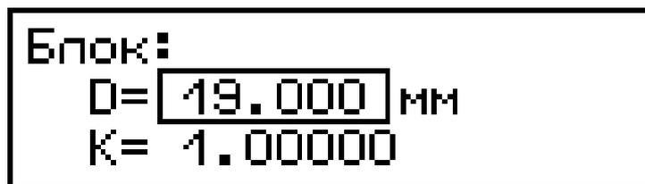
При помощи клавиш  $\downarrow$  ( $\uparrow$ ) установить числовое значение измеренного диаметра ведущего блока **D** и поправочного коэффициента **K**. После установки числового значения нажать клавишу **ВВОД**.
