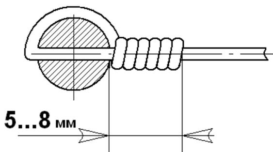
Рисунок 2.2 – Заделка струны
