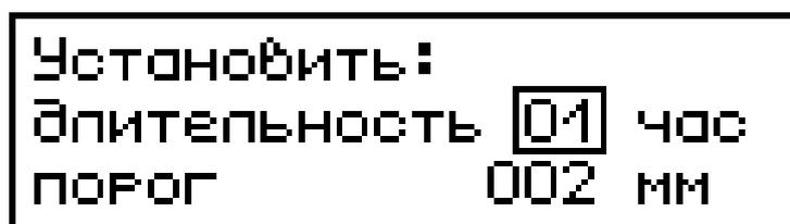
Клавишами ↓ (↑) установить требуемое значение длительности измерений и нажать клавишу **ВВОД**. Указатель курсора переместится на пункт «порог». Клавишами ↓ (↑) установить требуемый порог срабатывания и нажать **ВВОД**.
